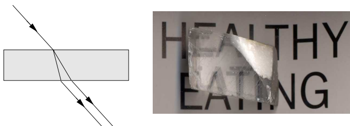
Abb. 3.5: Doppelbrechung: (links) Lichtstrahl spaltet in zwei verschieden gebrochene Strahlen auf; (rechts) Verdopplung des Bildes durch Calcit \text{CaCO}_3 .
