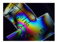
iv) Zwischen den Filtern werden zwei entgegengesetzte  $\lambda/4$ -Plättchen in den Lichtstrahl gelegt, und zwar eines auf jede Seite der Platte. Ein  $\lambda/4$ -Plättchen fügt eine relative Phase  $e^{\pm 2\pi i/4} = \pm i$  zwischen zwei ausgezeichneten linearen Polarisationen ein. Letztere sollen um 45° gegenüber dem Filterpaar gedreht sein. Zeige: Die Isochromaten bleiben, die Isoklinen werden unterdrückt.
